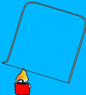
Das Becherglas beschlägt mit kleinen Tröpfchen einer farblosen Flüssigkeit. Dass es sich dabei um **Wasser** handelt, kann mit Blaufärbung des Indikatorpapiers „Watesmo“ nachgewiesen werden. (Blindproben mit Leitungswasser und Benzin o.ä.)
