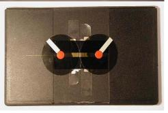
Versuchsergebnisse, die mit der hier dargestellten Anordnung erzielt wurden Der hier verwendete Laser sendet vertikal polarisiertes Licht aus. Der Laser muß etwa 1,5m vom Doppelspalt entfernt sein, um beide Spaltöffnungen auszuleuchten (ohne Strahlaufweitung durch eine Linse)
