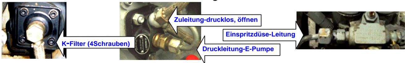
Der **Kraftstoff-Filter** ist manchmal im Tank eingebaut und \_\_\_\_\_. Meist ist nur die drucklose Zuleitung vom Tank zur Einspritzpumpe zu öffnen (Leitung an \_\_\_\_\_ **leicht lösen**). Der Tank ist am höchsten Punkt montiert – dadurch läuft der Diesel **ohne** \_\_\_\_\_ bei geöffneter Leitung nach und drückt die Luft heraus.
