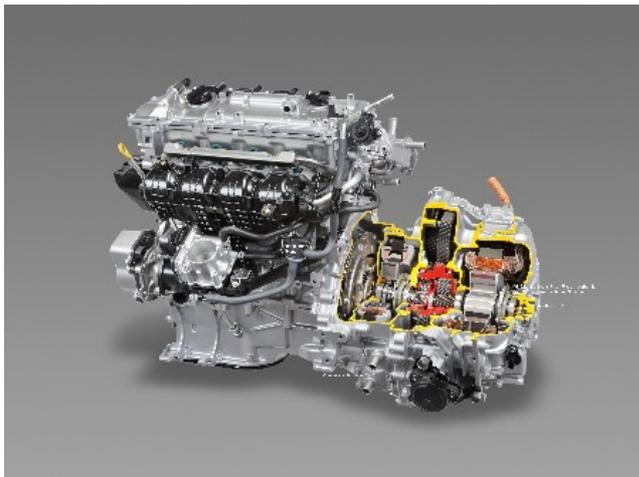
Drei Motoren treiben den Prius an. Einer der drei Motoren ist der Verbrennungsmotor. Um Kraftstoff zu sparen, arbeitet er im Atkinson-Zyklus. Dadurch verliert er in den niederen Drehzahlen an Drehmoment. Beim Atkinson-Zyklus werden die Ventile mit Variablen Steuerzeiten so bewegt, dass sich durch längeres Öffnen des Einlassventils nach dem unteren
