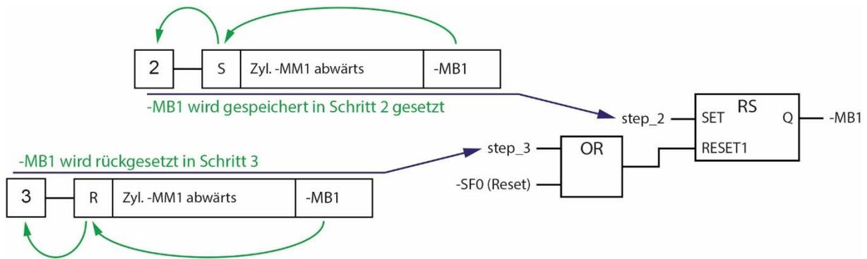
Der Magnet -MB2, verantwortlich für das Entspannen, wird nicht gespeichert angesteuert im Schritt 2. Da wir die Schritte bereits definiert haben und kennen, können wir diese auch zur Ansteuerung nutzen. Dazu rufen wir den Zustand des jeweiligen Schrittes über dessen Namen auf, z. B. für Schritt 2 step\_2. Somit haben wir den gesamten Ablaufplan in die Funktion-Bausteinsprache umgesetzt.
