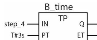
eines Timers. Realisiert wird die zeitbegrenzte Bestimmung „L“ des Schrittes 4 mit einem Impuls-Zeitglied, um die vorgegebene Biegezeit von 3 Sekunden einzuhalten. Der Zeitvorgabe am Eingang PT wird bezüglich der Aufgabenstellung mit 3 Sekunden belegt. Gestartet wird der Timer in unserer
