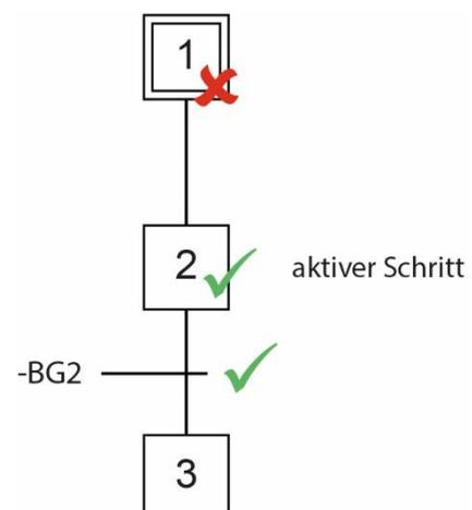
Den Nichtzustand des vorletzten Schrittes zu überprüfen macht Sinn, damit kein Schritt durch einen Zufall übersprungen wird. Zurückgesetzt wird der Schritt 3 wieder, indem Schritt 1 aktiv wird oder der Reset-Taster betätigt wird, um die Anlage in den Initialschritt 1 zu versetzen. Da die einzelnen Schritte als RS-Speicher definiert sind, kann direkt über ihren Objektnamen (z. B. step\_1) der logische Zustand abgerufen werden.
