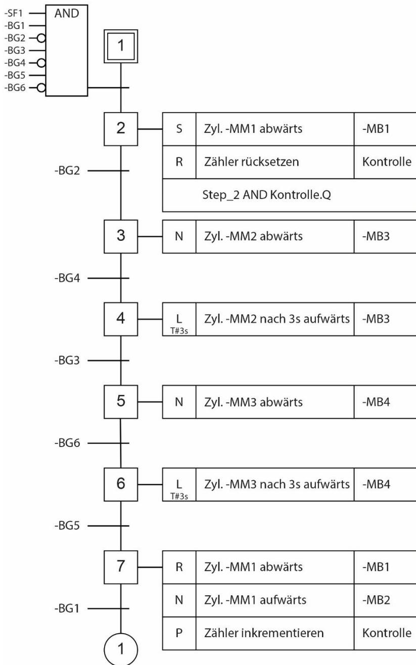
Im Rahmen der FUP-Programmierung ergeben sich hiermit zwei neue Netze. Zum einen der Aufwärtszähler (CTU) mit der Benennung Kontrolle, sowie die Ansteuerung der Leuchte -PF1.
