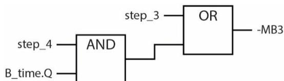
Betrachtung hier in Schritt 4, daher wird der Eingang IN mit der Abfrage des logischen Zustandes vom Schritt 4 gestartet (step\_4).
