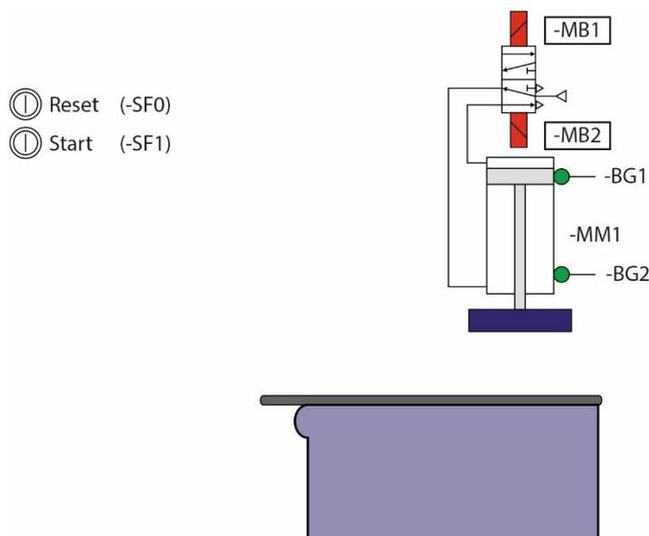
Hinweis: Der Zylinder -MM1 muss während des gesamten Biegevorgangs angesteuert werden.
