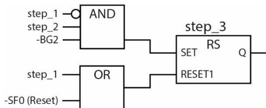
Analog verfolgt man nun dieses Vorgehen bei den Schritten 2 und 1. Die Neuerung bei Schritt 2 ist, dass hier nun das UND-Glied erweitert wird um die UND-Transition. Das ODER-Glied am Reset-Eingang des Speichergliedes wird wie bereits erläutert abgeleitet.
