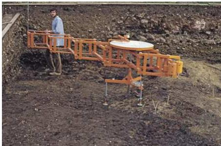
Mit unterschiedlichen Vermessungstechniken, Zeichnungen, Fotos und Beschreibungen wird dann alles genau dokumentiert. So wurde z.B. speziell für die Vermessung der Grabungen auf der Heuneburg der „Kartomat“ entwickelt, den man scherzhaft „Heunomat“ nannte. Auch Fotodrohnen kamen auf dem Gelände der Heuneburg zum Einsatz.
