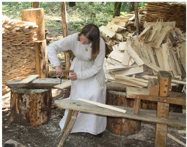
Produktion von Schindeln auf der Klosterbaustelle „Campus Galli“.
