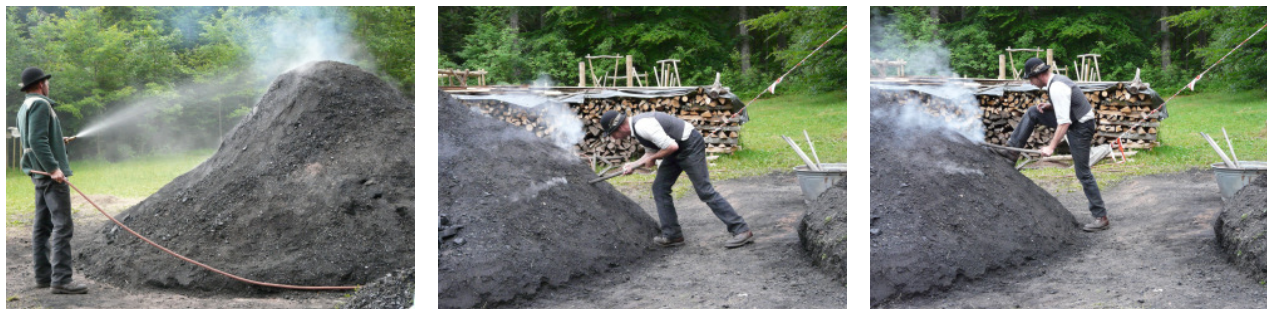
Köhler Thomas Faißt, Baiersbronn besprüht seinen Kohlenmeiler mit Wasser und sticht gezielt Luftlöcher hinein. (alle © Faist)
