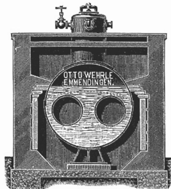
Der Zweiflammrohrkessel kann als zu bevorzugendes Betriebsmittel für alle diejenigen Fälle betrachtet werden, in welchen neben dem nötigen Aufstellungsplatz auch ein vorzügliches Brennmaterial und ein gutes Speisewasser zur Verfügung stehen.
