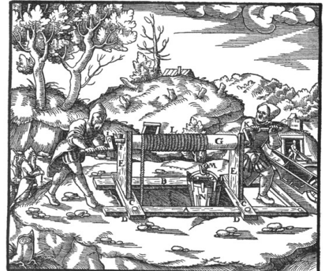
Der vorn am Schacht verlegte Pfehlbaum A. Der hinten am Schacht verlegte Pfehlbaum B. Die zugspürten Pfehle C. Die Querhölzer D. Die Halspfehlhölzer E. Die Pfahlsisen F. Der Rundbaum G. Seine Zapfen H. Das Holz I. Die Karbel K. Das Förderseil L. Der Seilhaken M. Das Fördergefäß N. Sein Bügel O.
