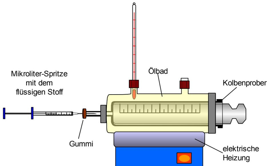
Zur Bestimmung der Molmasse wird eine genau abgemessene Menge des Stoffes verdampft und das zugehörige Gasvolumen bestimmt. Da nach Avogadro ein Mol jeden Gases ein Volumen von 22,4 L bei Normalbedingungen (273 K, 1013 hPa) einnimmt, kann über einen Dreisatz die Molmasse bestimmt werden, wenn man zuvor das Gasvolumen auf Normalbedingungen umgerechnet hat.
