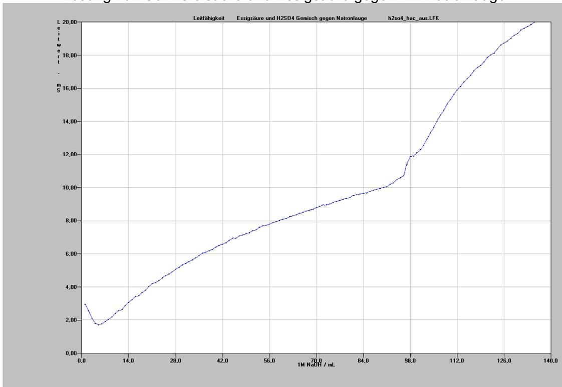
Durch Leitfähigkeitstiteration kann die Konzentration starker neben der Konzentration einer schwachen Säure quantitativ nachgewiesen werden.
