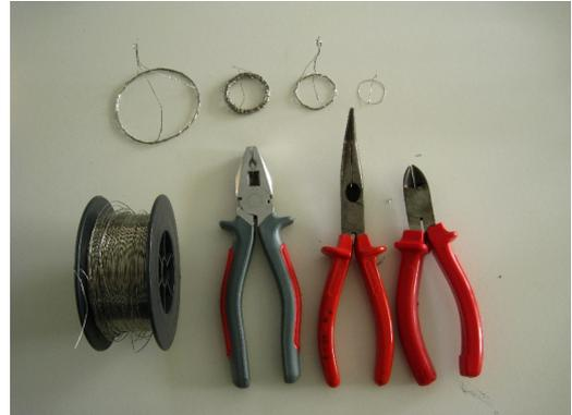
Die verschiedenen Ringe wurden mit Draht hergestellt. Die Rundung des Drahtes gelingt gut, wenn man ihn z.B. um verschieden dicke Bechergläser windet.
