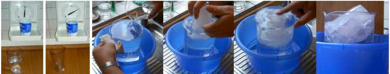
Zum zweiten Bild von rechts. Das Eis wird mit dem Finger bis zur Wasseroberfläche hinuntergedrückt und das Volumen des übergelaufenen Wassers mit einem Messbecher bestimmt.
