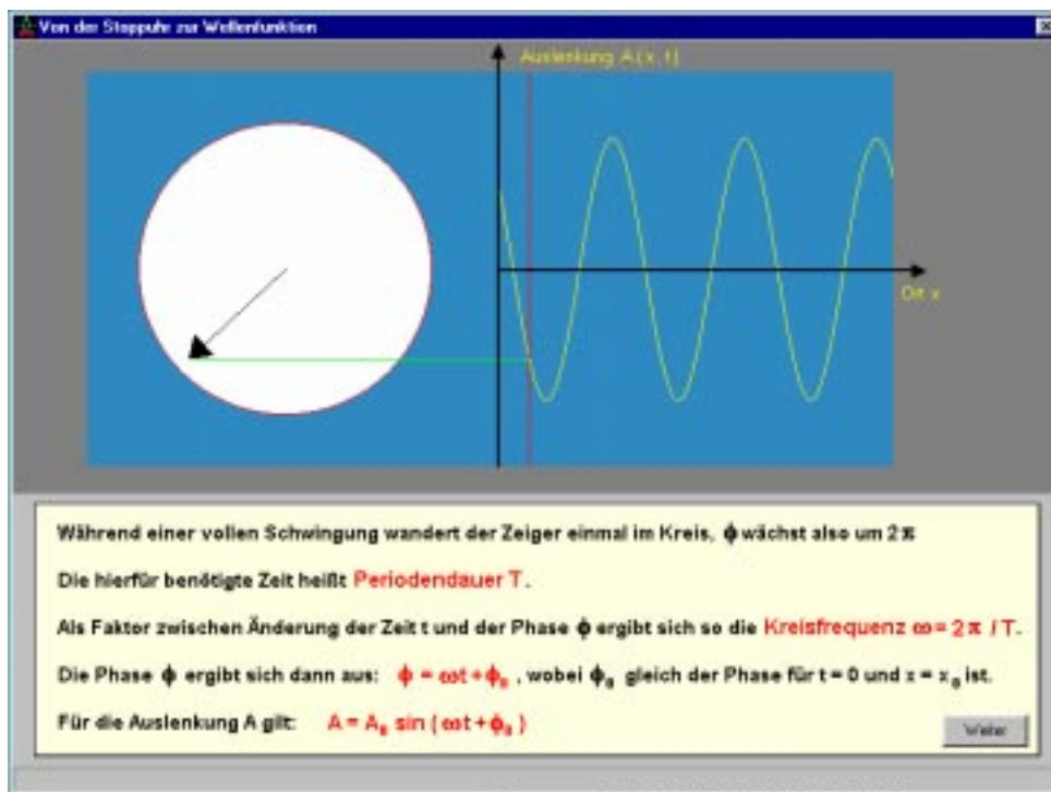
Abbildung 14: Die Abdeckung ist entfernt, der Ort, an dem die Wellenfunktion von der Uhr beschrieben wird, ist durch den senkrechten roten Balken markiert. Periodendauer, Kreisfrequenz und deren Bezug zur Phase werden erläutert.
