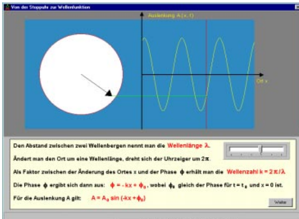
Abbildung 16: Der Zusammenhang zwischen Wellenlänge, Änderung des Ortes und der Zeigerstellung der Uhr wird verdeutlicht.
