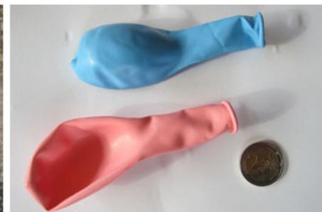
Abbildung 2: kleiner Luftballon als „Rückschlagventil“; Schraubdeckel mit gekürztem Auslassröhrchen [alternativ aufgesteckter PVC-Schlauch] einer Spritzflasche; großer Luftballon zur elastischen Abdeckung des offenen Bodens
