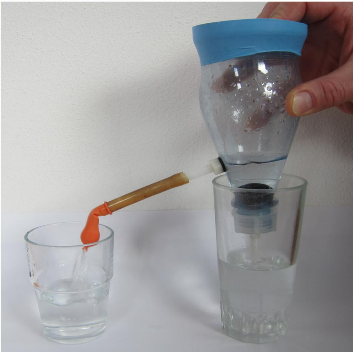
**Abbildung 1:** Das Modell in Aktion. Zum Gebrauch mit SuS wird empfohlen, die Membran (blau) mit Panzertape (duct-tape; gaffa-tape) zu befestigen und ein schlanke hohes Becherglas mit Ausgussnase zu verwenden, in das sich die Polyamidschraube des Modells bequem einlegen lässt.
