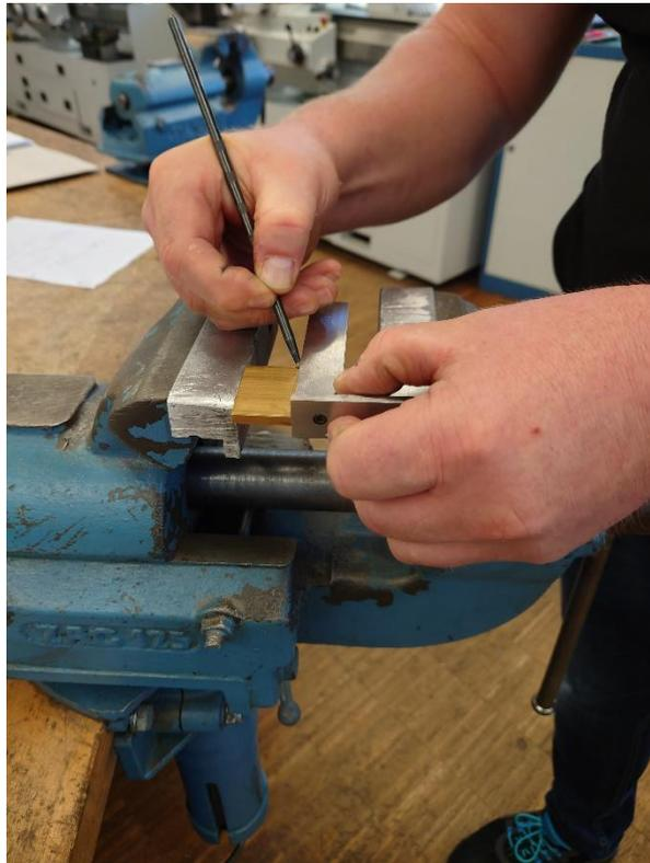
Anreißwerkzeuge werden in der Metalltechnik, aber auch in der Holzbearbeitung, verwendet. Sie finden sich in kleineren Werkstätten, aber auch in Großbetrieben. Anreißwerkzeuge werden für das Anzeichnen auf harten oder glatten Oberflächen verwendet, weil auf solchen Materialien Markierungen mit Stiften oft nicht gut halten. Mit Anreißnadeln oder anderen Anreißwerkzeugen ist dies trotzdem möglich, da die Markierung direkt in das Material geritzt wird.
