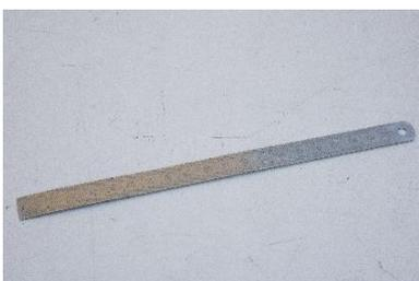
Bezeichnung: \_\_\_\_\_ Stahlmaßstab \_\_\_\_\_
