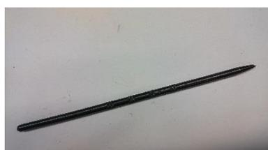
Bezeichnung: \_\_\_\_\_ Anreißnadel \_\_\_\_\_
